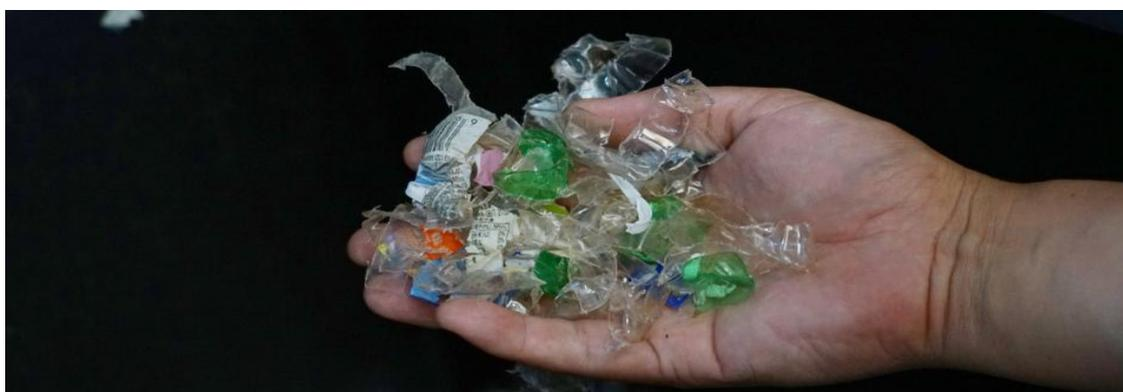
图 5-1 废弃塑料瓶经过破碎减量后得到的塑料片
