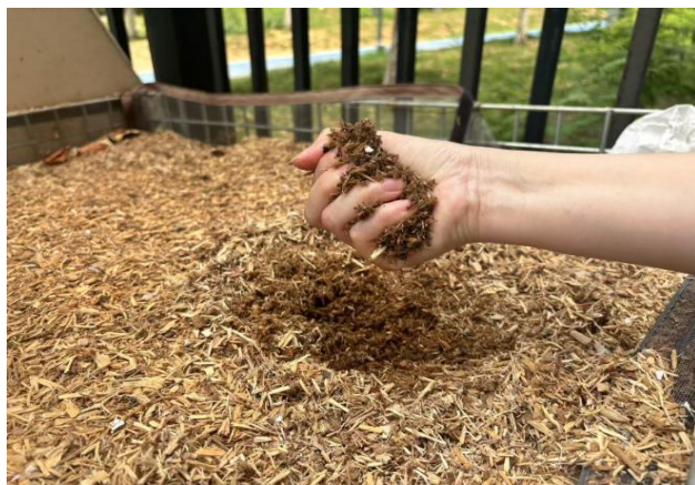
图 1-1 检测湿度简易法示意图
